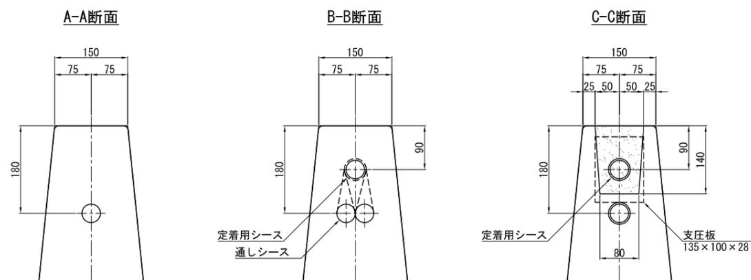
PC鋼より線(アンボンド被覆材)の端部処理概要図 S=1/5
