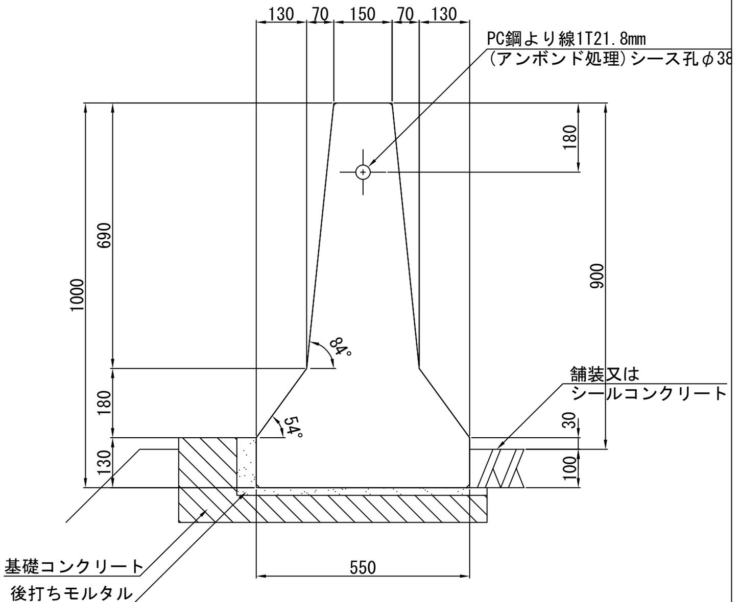
プレキャスト防護柵PC鋼材定着ブロック緊張ケーブル配置詳細図 ④
